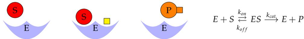
Se representa por  $s(t), e(t), c(t), p(t)$  a las concentraciones a tiempo  $t$  del sustrato, la enzima, el complejo enzima-sustrato y el producto, respectivamente. Bajo cinética de acción de masas se obtiene entonces el sistema de ecuaciones diferenciales:
