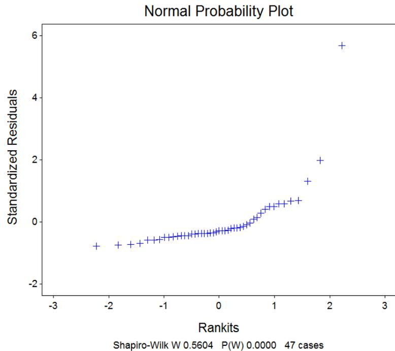
El QQ-plot muestra un importante apartamiento de la normalidad y el test de Shapiro-Wilk tiene un p-valor inferior a 0.0001
